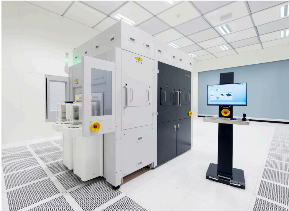
圖_EV Group 的 EVG®40 NT2 自動化檢測系統為 W2W、D2W、D2D，以及無光罩微影應用，提供疊層與 CD 測量。
