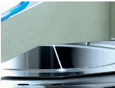
省スペース化およびメンテナンス頻度を最小限に抑え、高スループットの常温剥離を実現したレーザー剥離モジュール
