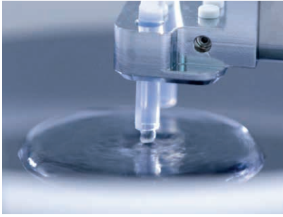
高精度なエッジ塗布プロセスを実現するアライメントユニット付きスピコートモジュール
